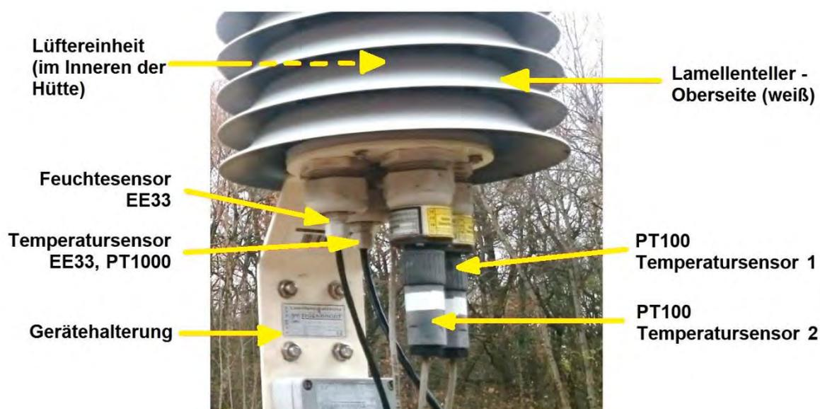
Abbildung 2: LAM630 Thermometerhütte mit Sensoren
