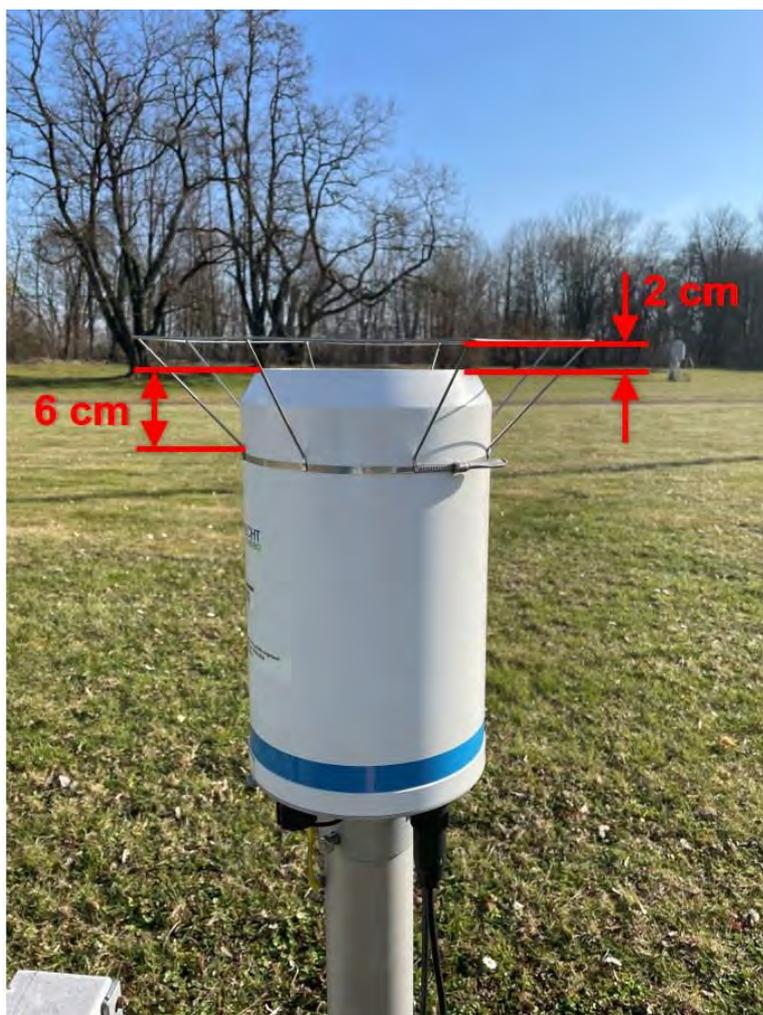
Abbildung 23: Höhe Befestigung Vogelschutzring
