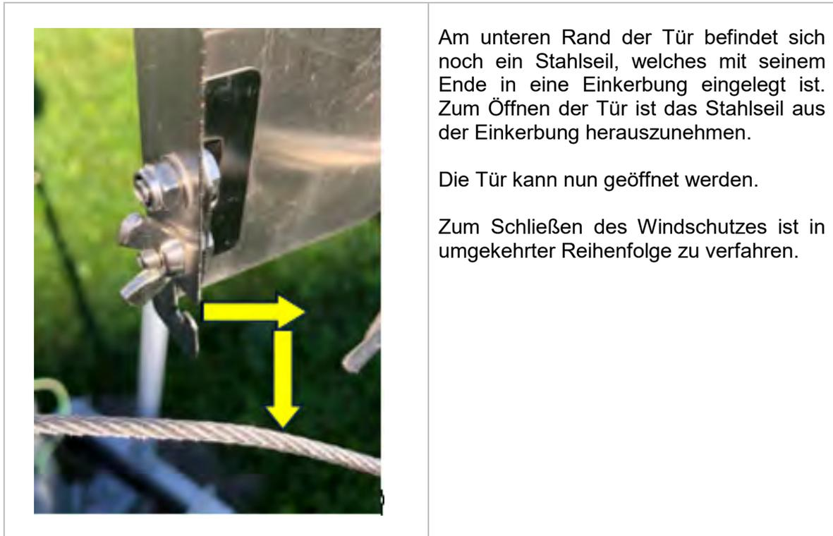
Am unteren Rand der Tür befindet sich noch ein Stahlseil, welches mit seinem Ende in eine Einkerbung eingelegt ist. Zum Öffnen der Tür ist das Stahlseil aus der Einkerbung herauszunehmen.
