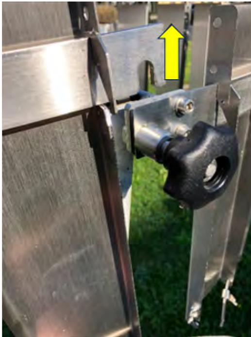
Um die Tür des Windschutzes zu öffnen, muss im ersten Schritt die Rändelschraube (schwarzes Drehrad) am oberen Rand des Windschutzes um einige Drehungen gelockert werden (gegen den Uhrzeigersinn).
