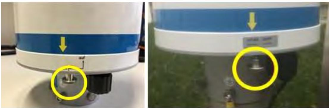
Abbildung 9: Rändelschraube Rain[e]
